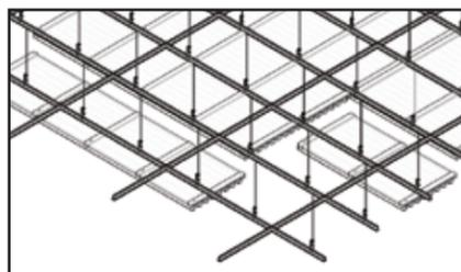
La mayor parte de los modelos tanto de 1200x600mm como de 2400x600mm se pueden instalar bajo una perfilera de falso techo estándar T24 de 1200x600mm mediante unas pletinas deslizantes.
