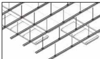
Todos los modelos también se pueden montar atornillados debajo de un rastrelado fijado al techo como por ejemplo un rastrelado de perfiles T60 tipo Pladur.
