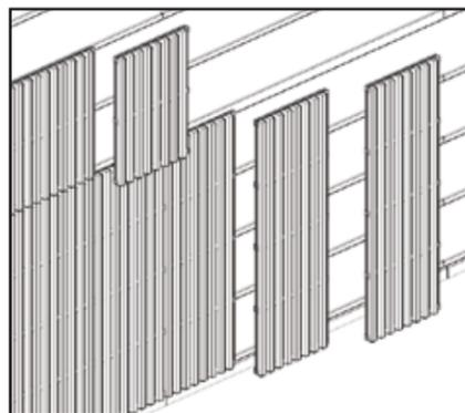
Los paneles alistonados se montan atornillados sobre un rastrelado de madera que sirve tanto para nivelar la pared como para incrementar la absorción acústica.
